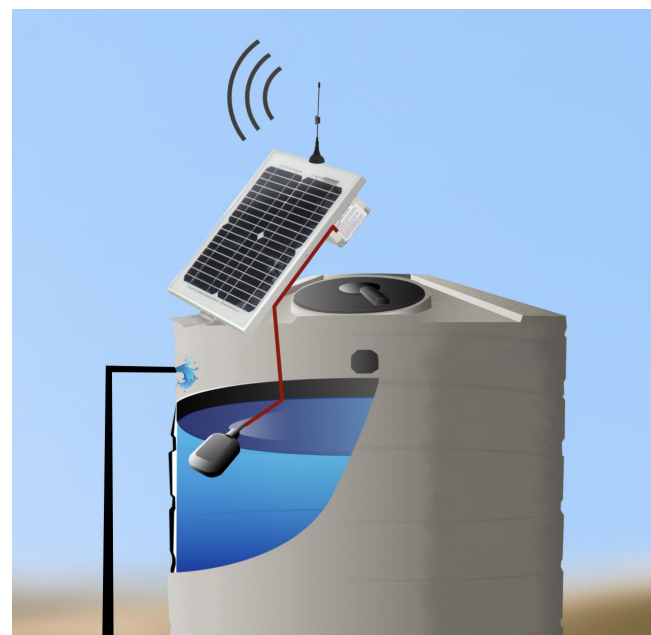
Transmisor en Extremo del Tanque
